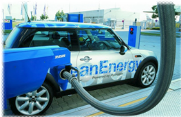
3. ábra: Hidrogénüzemű üzemanyagcellás autó prototípusa
