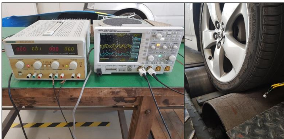
3. ábra A mérőadatgyűjtő rendszer a saját fejlesztésű, gazdaságos mikrofonhoz.
