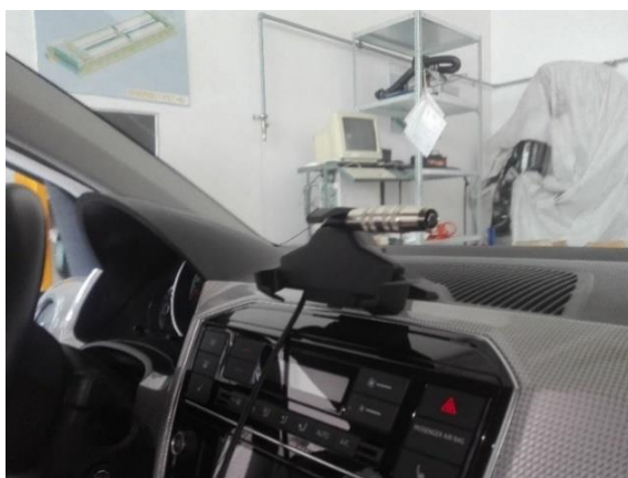
8. ábra Ipari mikrofon elhelyezése az utastérben
