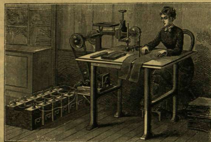
Szabászati gép, melyet akkumulátor mozgat.
