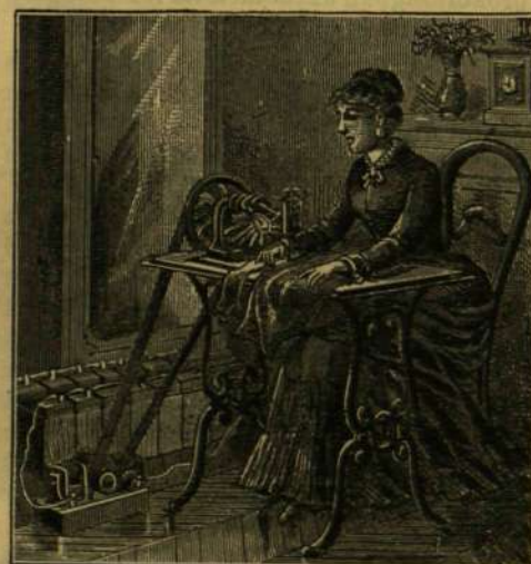
Varrógép, melyet akkumulátor hajt.
