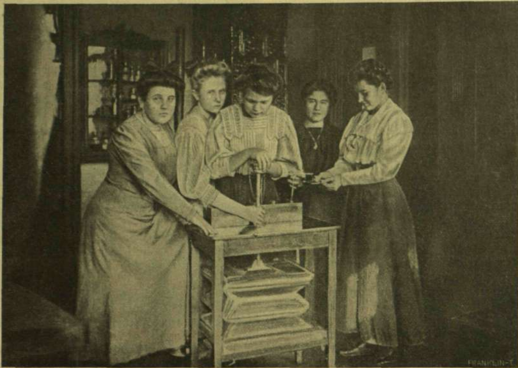
FUJTATÓVAL GYORSÍTJÁK A FOLYADÉK PÁROLGÁSÁT ÉS FAGYÁST IDÉZNEK ELŐ.
