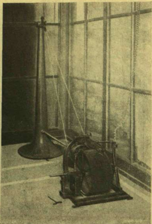
BOSCH-FÉLE FÖLDRENGÉS-JELZŐ-KÉSZÜLÉK A BUDAPESTI FÖLDRENGÉSI OBSZERVÁTORIUMBAN.
