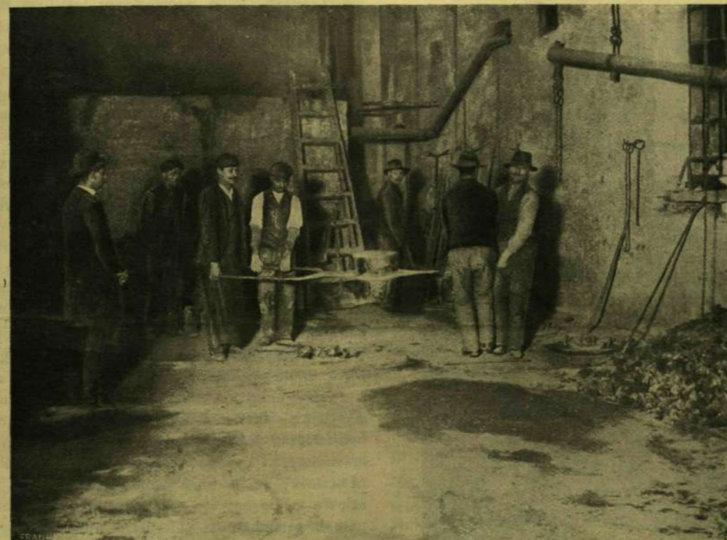
AZ OLVASZTOTT BRONZOT GRAPHIT-TÉGELYBEN A SÜLYESZTŐ GÖDÖRBE LEVŐ FORMÁHOZ VISZIK.
