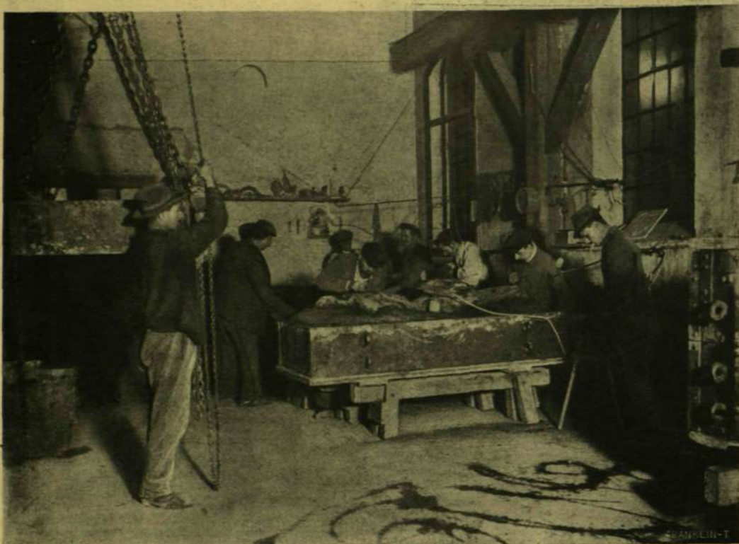
HOGY KÉSZÜL A SZOBOR? — Az eredeti gipsz-mintát kifomázzák homokban.
