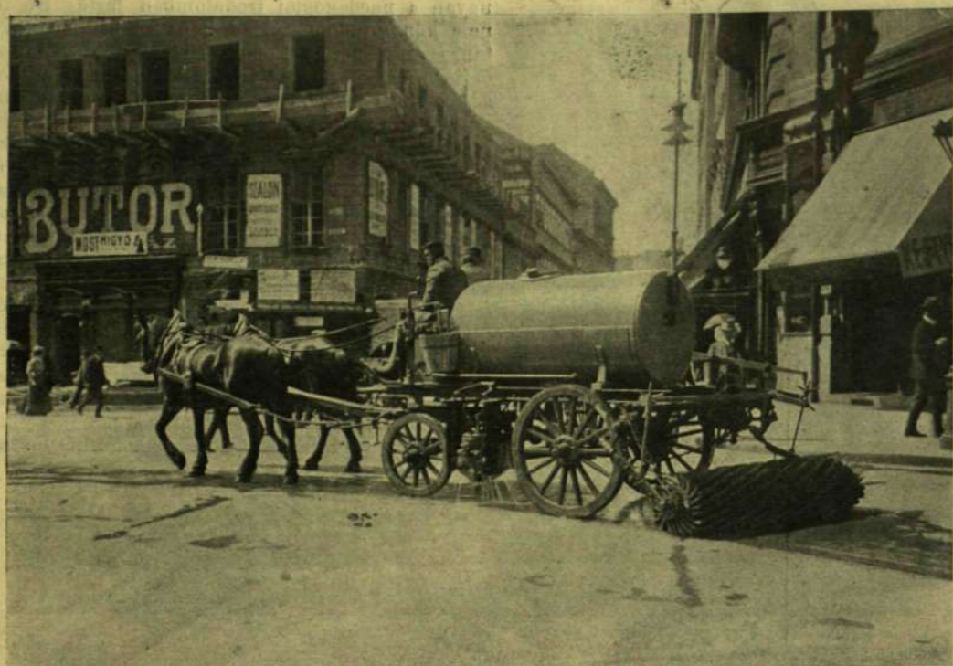
A FŐVÁROS ÚJ RENDSZERŰ UTCAI ÖNTÖZŐ-GÉPE.
