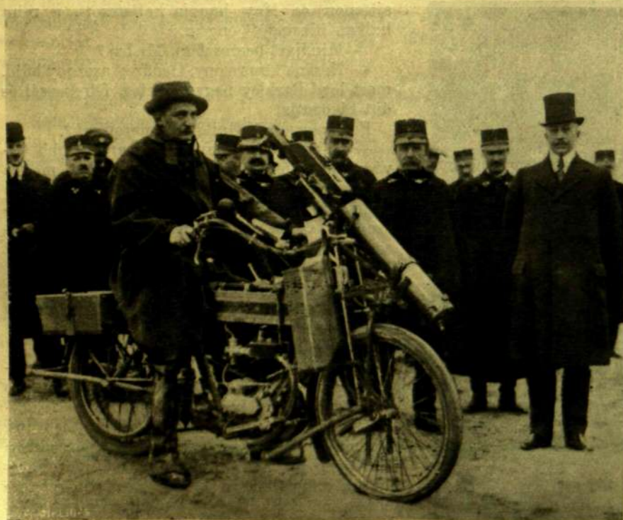
EGY HOLLANDI KERÉKPÁROS ÚJ HADI TALÁLMAJA: MOTOROS KERÉKPÁRRA ILLESZTETT MITRAILLEUSE.
