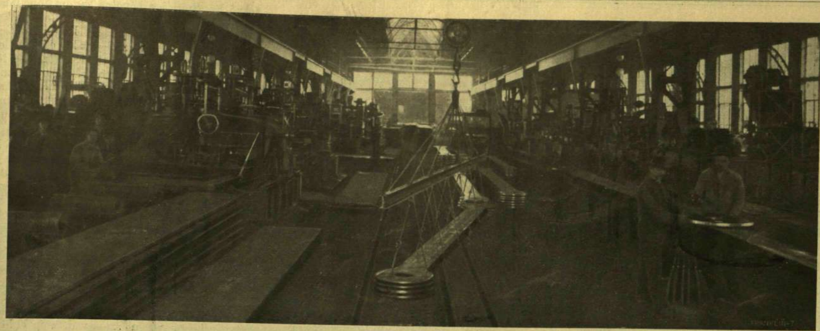
A LÁNCZTAGOK MEGMUNKÁLÓ MŰHELYE. (Jobbról látható a láncztagok reszelése).
