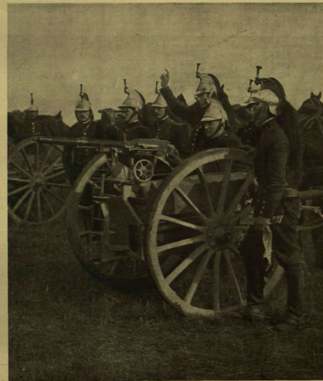
A HOTCHKISS-FÉLE FRANCZIA GÉPFEGYVER MŰKÖDÉS KÖZBEN
