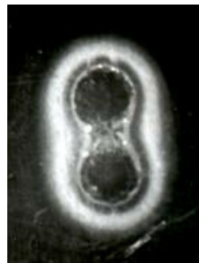
4. fotó: Kettős körlyuk, Zn^{++} \rightarrow Cu lemezre
