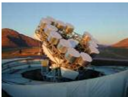
A Cosmic Background Imager 13 önálló, de egymással összekapcsolt és együttműködő rádióteleszkópból áll, amelyek mindegyike 90 cm átmérőjű. Az antennák a mikrohullámú tartományban interferométerként működnek
