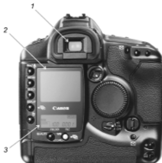
3. ábra Canon EOS-1Ds pentaprizmás tükrörreflexes digitális gép hátulról 1. optikai kereső 2. folyadékkristályos kereső 3. beállítások követését szolgáló kijelző
