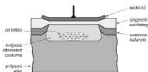
1. ábra CCD cella keresztmetszet – a cellasor csatornájára merőlegesen
