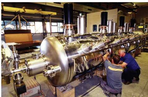
A nagyfrekvenciás elektromágneses teret keltő gyorsító-egység, szerelése
