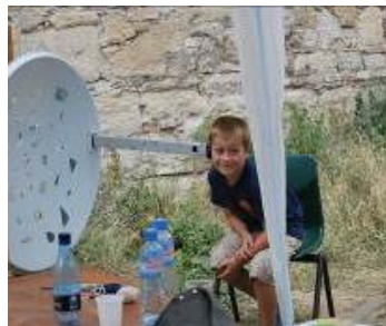
Suttogás és annak meghallgatása a parabolaantenna fókuszában.
