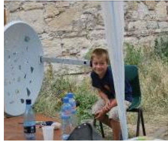
Suttogás és annak meghallgatása a parabolaantenna fókuszában.
