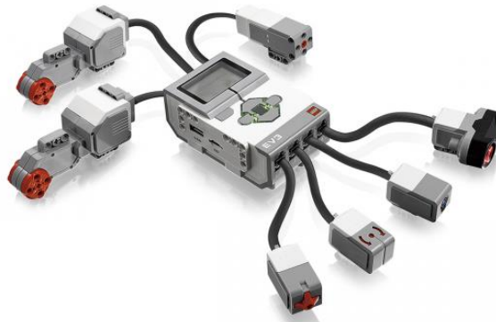
2. ábra: Az EV3 téglá motorokkal és érzékelőkkel
