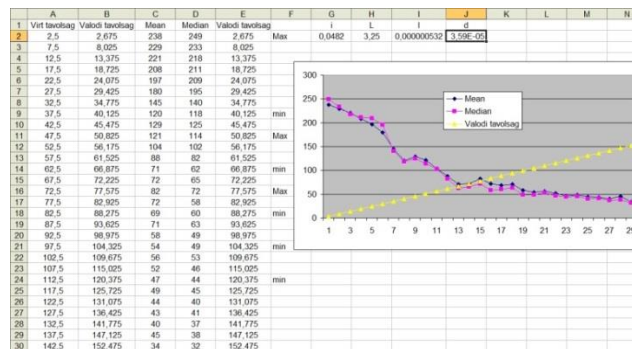
5. ábra. A diffrakciós kép feldolgozása Excel táblázattal
