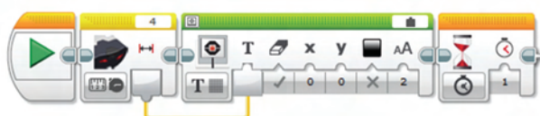
48. ábra: Az infravörös érzékelő által mért távolság (a visszatérési érték) kiírása
