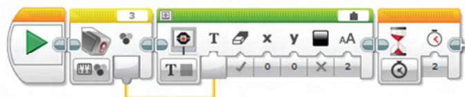
38. ábra: A színérzékelő visszatérési értékének kitérése
