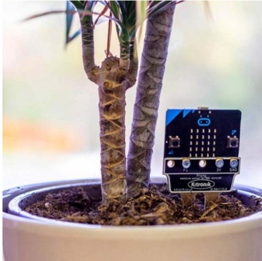
7. ábra: Virágföldek nedvességtartalmának mérése
