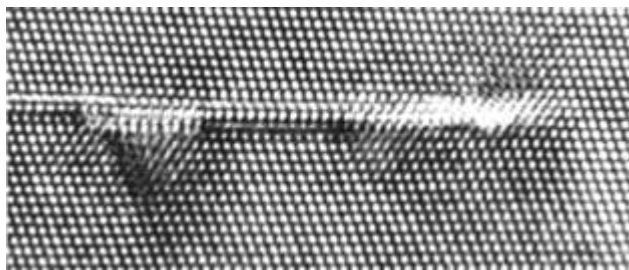
1. ábra. Nagyfelületű pn-átmenet n-, illetve p-típusú szeletek direkt kötésével való előállítás. (Az illesztés 1,5^\circ -os, nem-szándékos rotációs hibája miatt, ahogy az várható is, minden 40. atomnál diszlokáció keletkezett; Pécz B., Gyulai J., Wiget R., Burte E.P.: Silicon direct wafer bonding, a TEM study. Proc. EUREM-11 , Dublin, 1996, Vol. II. pp. 638–639.)
