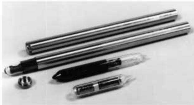
2. ábra. A kapszulanyítás az Eötvös-kísérletben: az acélkapszula, alatta a kissé kihúzott kvarcampaulla, azután a fedél és a GaSb ampulla, végül a GaAs ampulla.
