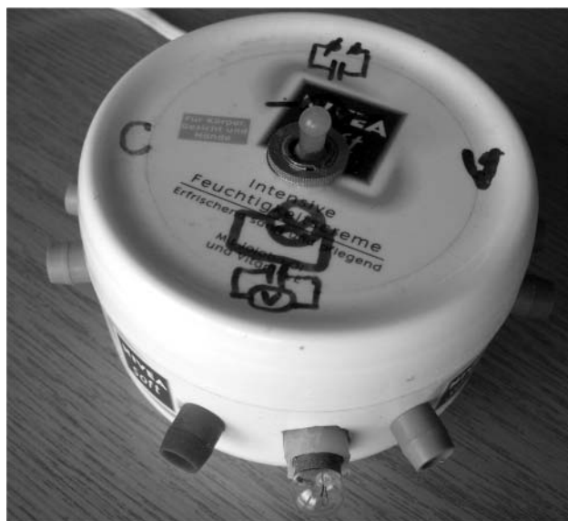
9. ábra. Az átkapcsoló gyakorlati kivitelezése
