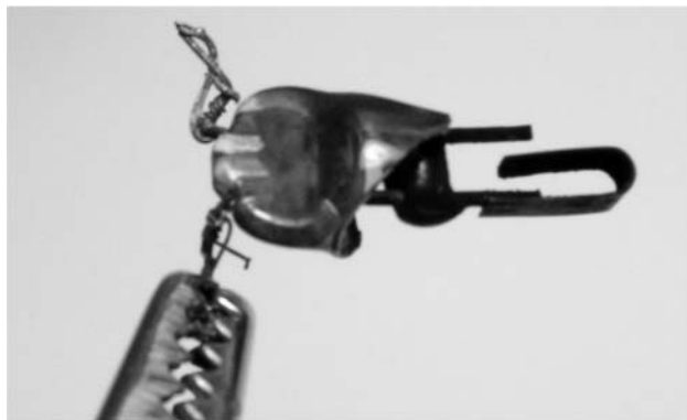
13. ábra. A gyújtó bimetalkapcsolója
