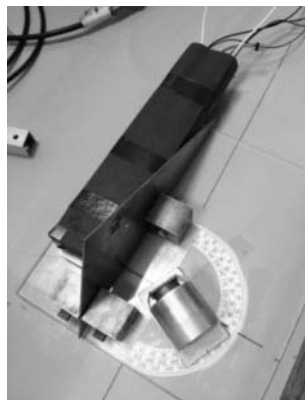
3. ábra. Az elektronszórást vizsgáló mérés összeállítása.
