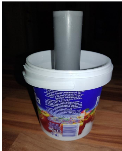
1. ábra. A XXVI. Országos Szilárd Leó Verseny kísérleti fordulóján használt mintatartó. A joghurtos edénybe töltött káliumtartalmú műtrágya körbeveszi a szürke csöbe helyezhető Geiger–Müller-számlálócsövet
