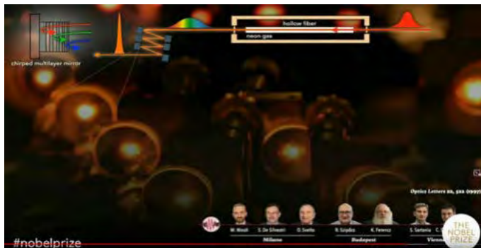
7. ábra. 5 fs-os, szub-mJ energiájú lézerpulzusok előállítása nemesgázzal töltött üvegek kapillárisában nagy energiájú, ~20 fs-os lézerpulzusok spektrális kiszélesítését majd csörpölt tükrökkel történő diszperziókompenzálását követően [1, 12]
