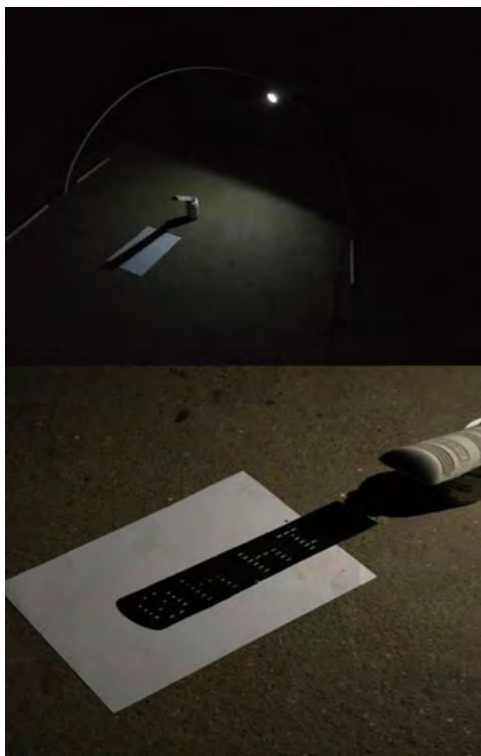
6. ábra. A Nap járását demonstráló eszköz, digitális napórával
