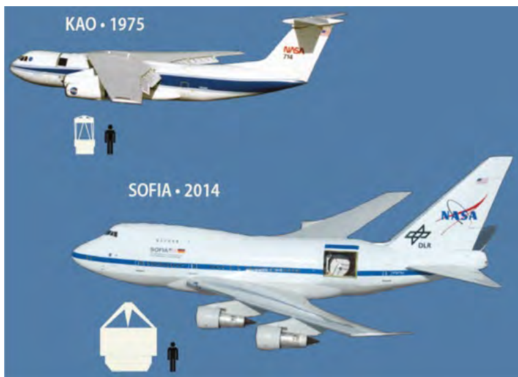
1. ábra. A NASA repülőgép fedélzetére helyezett KAO és a SOFIA infravörös obszervatóriumai. A fedélzeti távcső méretét a repülőgép alatti kis piktogram szemlélteti. (Forrás: NASA/SOFIA/L. Proudft – közkincs)
