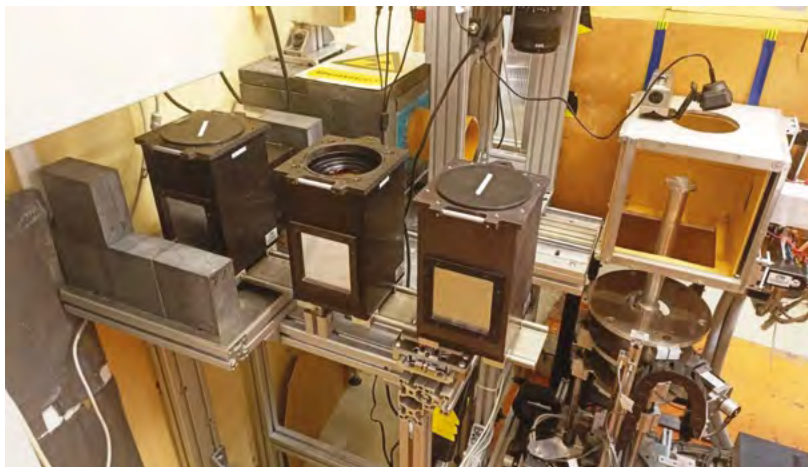
12. ábra. A három sínen mozgatható cserélhető optikai előtét
