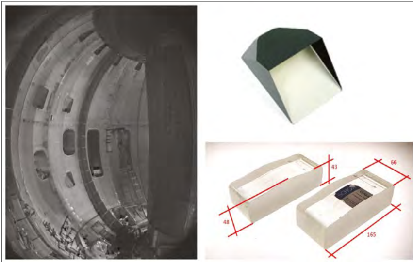
9. ábra. A JT-60SA EDICAM kamerával készült képe (forrás: JT-60SA), a prizma üveganyaga és a kész prizma
