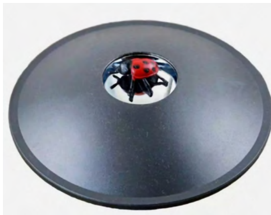
2. ábra. Parabolatükrökkel előállított valódi kép (Forrás: https://www.ebay.com/itm/285656953619 )
