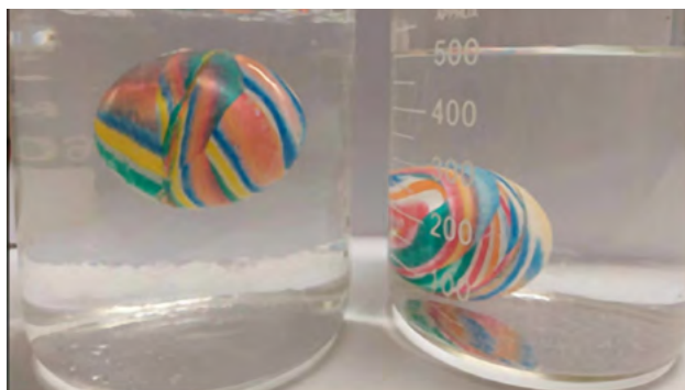
3. ábra. Gumilabda vízben vízgyönggyel és vízgyöngy nélkül
