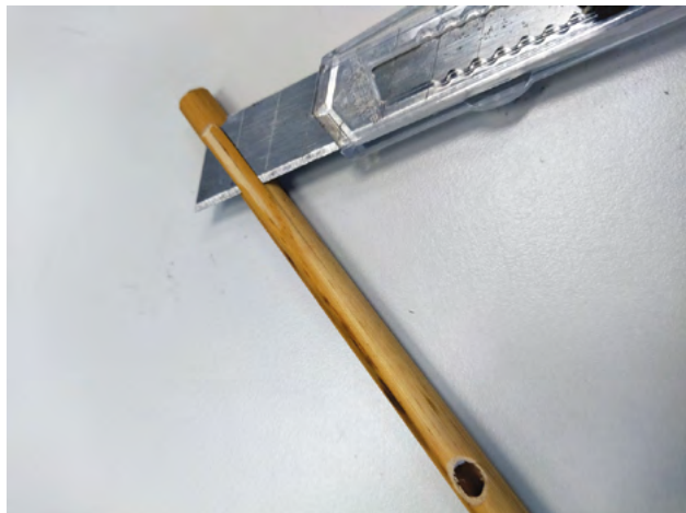
4. ábra. Nyelvsíp készítése
