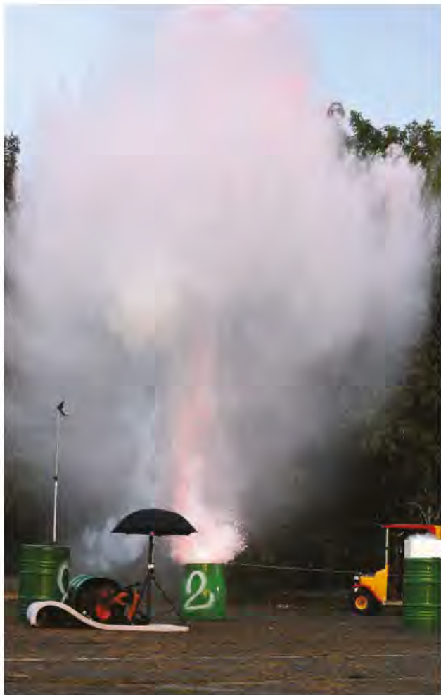
9. ábra. Hordó alakítása lökéshullámmal
