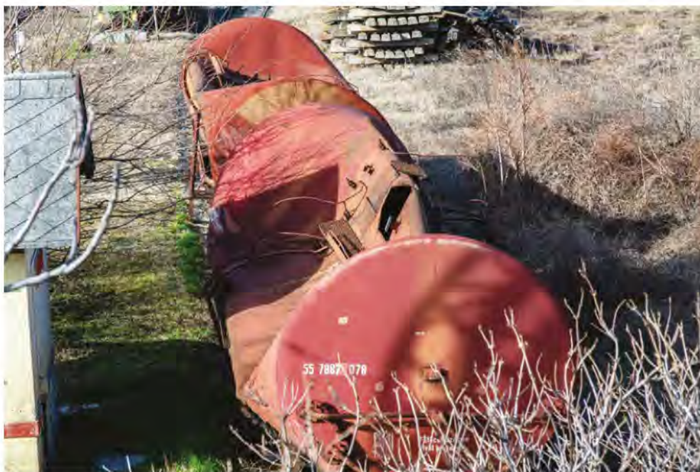
4. ábra. Összeroppanó vasúti tartálykocsi
