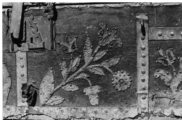
20. kép. A gyergyói vasas láda korrózió következtében kitördelzett, hiányos pántjai
