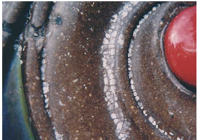
2. kép. A mélyedésekben, ahol megáll a víz, erősebb a só lerakódása
