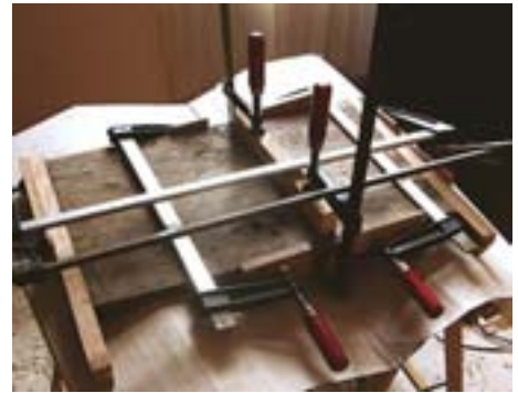
79. kép. A tető deszkáinak ragasztása és az új fejelőlécek felhelyezése.
