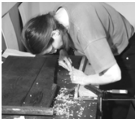
16. ábra. A ládate- tő kiegészítésének faragása.
