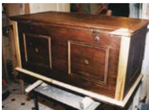
28. kép. A tímár céh ládája a profil- lécek és kitört elemek kiege- szítése után.
