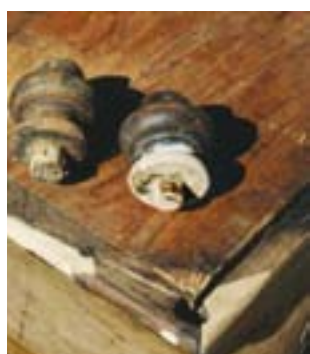
18. kép. A profillécek és a lábak kiegészítése.
