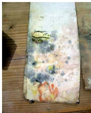
6. kép. Penészgomba által megtámadott bőrkötés.
