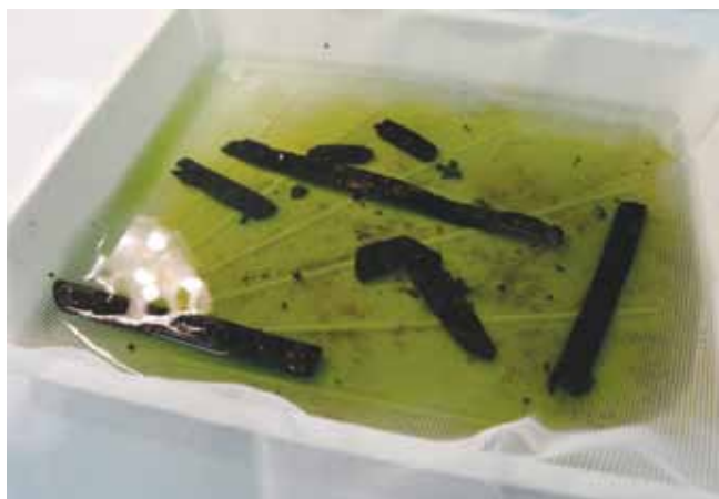
8. kép. Réz korróziós termékkel szennyezett töredékek tisztítása Selecton B2 oldatában. A fürdő zöld színe jelzi a rézvegyületek kioldódását.
