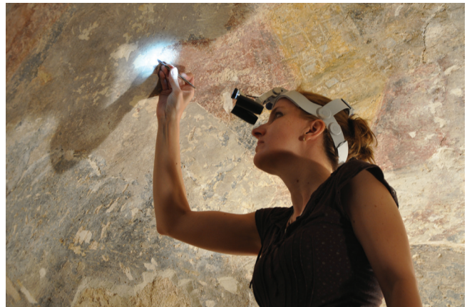
10. kép. Feltárási próba fejmikroszkóp alkalmazásával.
