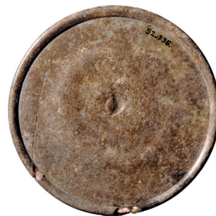
7. kép. Elüvegtelenedett peremezett tányérüveg a középkorból.
