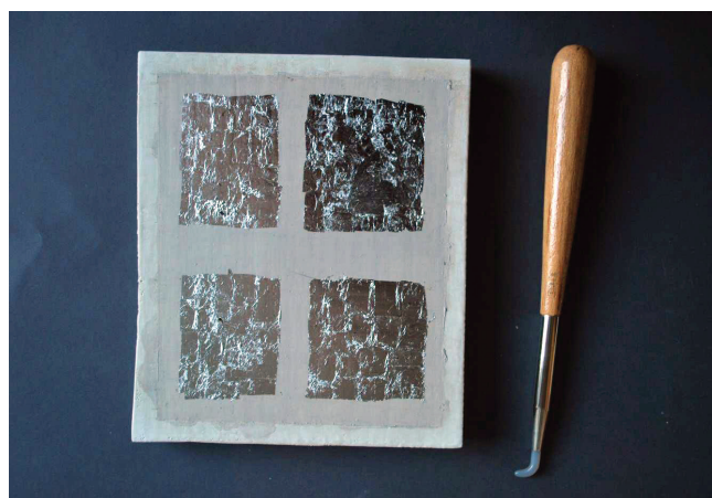
22. kép. Az ezüstözött próbafelületek és a polírozáshoz szükséges achátkő.
