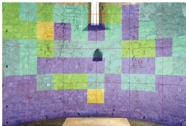
Pécsvárad, várkápolna szentély, falnedvességi értékek 2014.05.09. GANN UNI1 Bóna I., Kúrtósi B.
