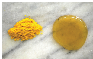
16. kép. Berliini kék pigment és lenolaj kötőanyag (Tövissi Júlia felvétele).
