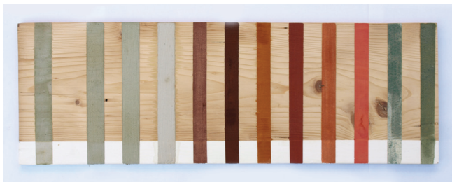
8. kép. Kós és Kardalus közlései alapján összeállított színskála a Hargita hegység környékén előforduló nyersanyagokból. A kötőanyag kazein.
