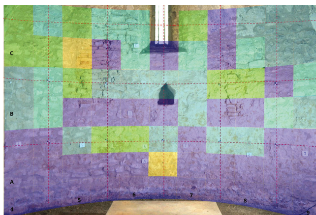
Pécsvárad, várkápolna szentély, falnedvességi értékek 2014.05.09. GANN UNI Bóna I., Kúrtósi B.
