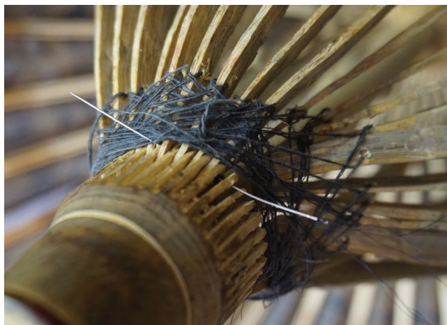
15. kép. A küllők csúszógyűrűbe való rögzítése selyemszálakkal (a szerző felvétele).
