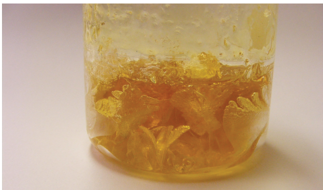
8. kép. Hőpolimerizálás hatására kialakult jégvirágszerű fázisok a térhálóban (a szerző felvétele).
