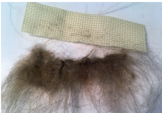
13. kép. A kongré hordozóról levált nemezelt réteg.
