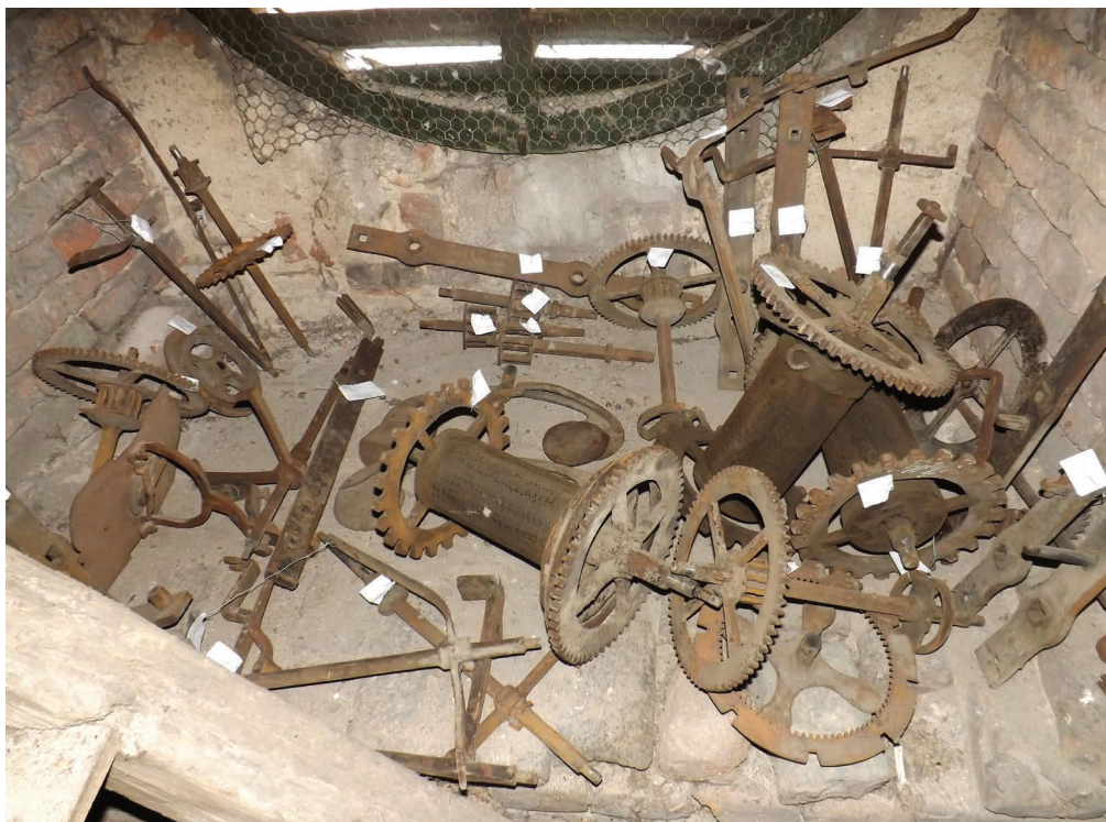
11. kép. A szétszerelt újvárosi óraszerkezet alkatrészei.
