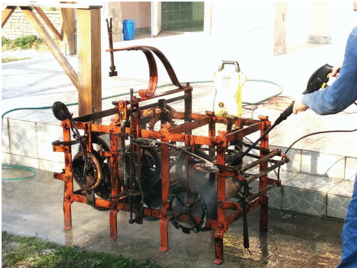
28. kép. Tisztítás magasnyomású vízsugárral.
