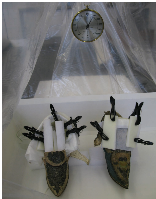
12. kép. A cipők formára igazítása páraaknában.
