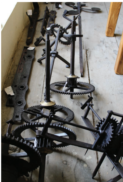
17. kép. Az újbárosi óramű alkatrészei konzerválás után, összeszerelés előtt.
