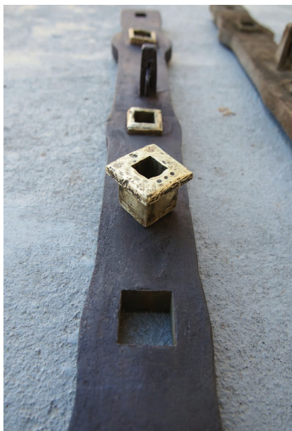
18. kép. Cserélhető sárgaréz perselyek tisztítást követően.
