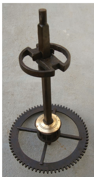
16. kép. Csersavval passzivált alkatrész.
