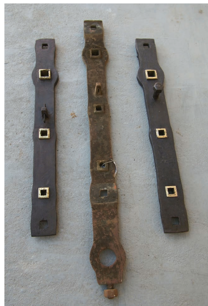
19. kép. Alkatrészek tisztítás előtti és konzerválás utáni állapota.
