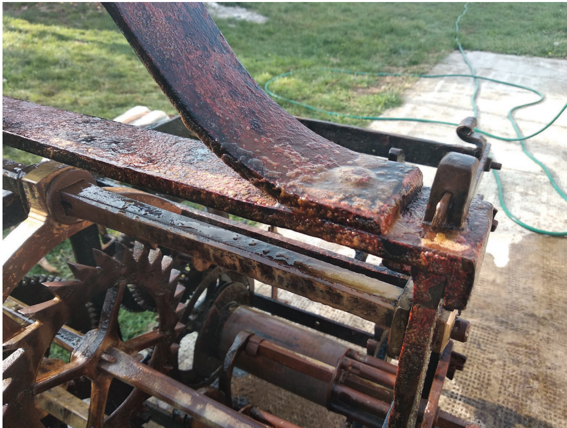
27. kép. Tisztítás ipari zsirolóval.
