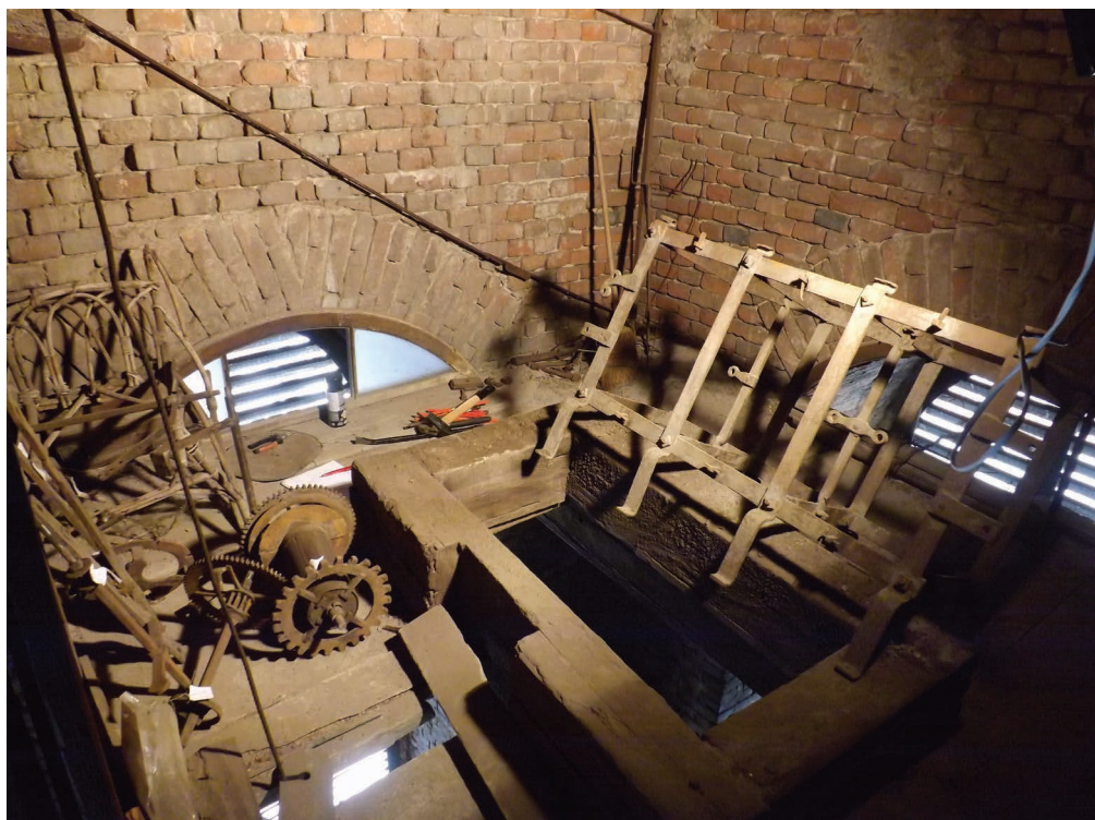
10. kép. Az újvárosi óraszerkezet szétszerelés közben.
