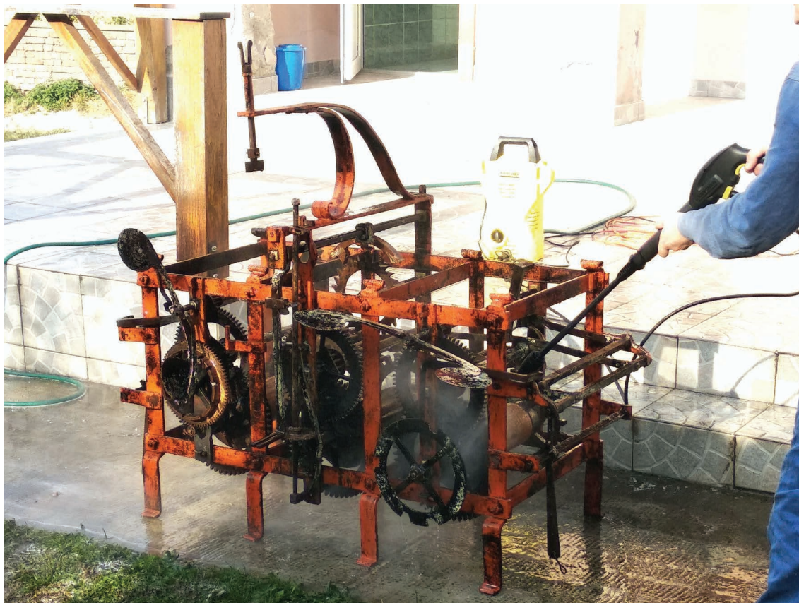
28. kép. Tisztítás magasnyomású vízsugárral.
