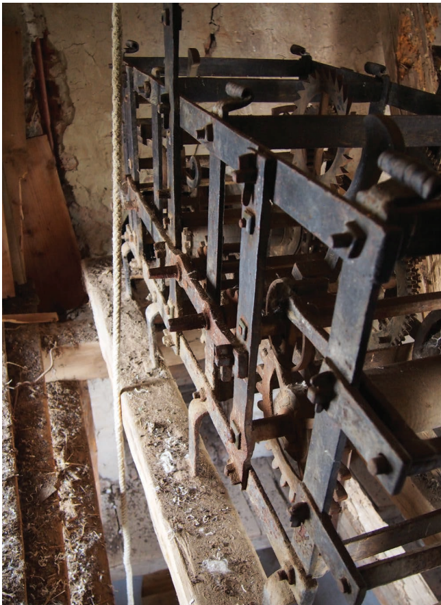
8. kép. A hegyközcsatári erősen szennyezett óraállás.
