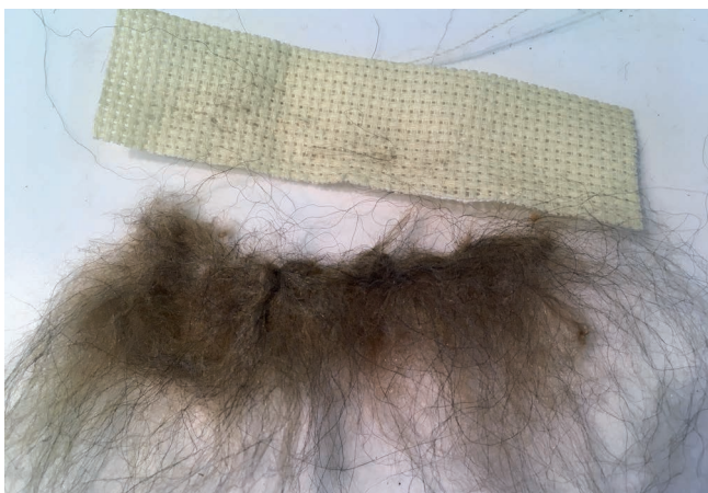
13. kép. A kongré hordozóról levált nemezelt réteg.
