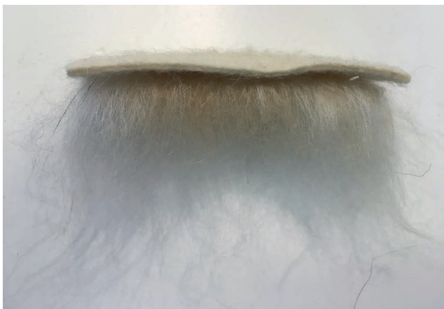
11. kép. Filc hordozóba tűzött szálak.
