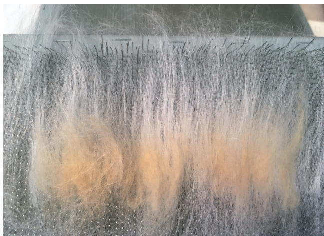
7. kép. A növényi szálásanyag (fehér) rögzítése gyapjú réteggel (okker) történt.
