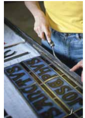
f. Az üvegek szélének csiszolása. g. A festés második része: a már beégetett, kontúrozással megfestett fej és a lábak külső oldali festése színes zománcfestékkel az előzetes próbaégetéssel. h. A megfestett portré. i-j. A festett üvegszemek összeölmözása ölmözősá-talon az ölmözősi karton segítségével.
