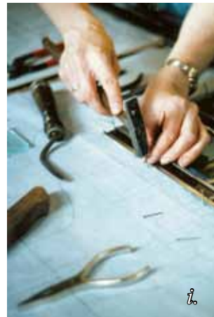
f. Az üvegek szélének csiszolása. g. A festés második része: a már beégetett, kontúrozással megfestett fej és a lábak külső oldali festése színes zománcfestékkel az előzetes próbaégetéssel. h. A megfestett portré. i-j. A festett üvegszemek összeölmözása ölmözősá-talon az ölmözősi karton segítségével.
