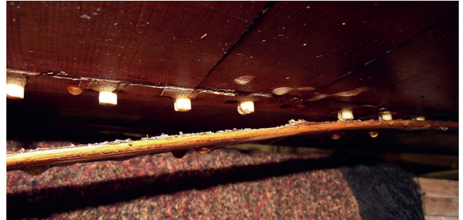
27. kép. A felső húrtartó részleges eltávolítása. A duzzasztás idejére a hangszekrényt megfordítottuk, hogy a rezonátor minél kevésbé legyen kitéve a felső húrtartóról lecsöpögő Metylan pép nedvesítő hatásának
