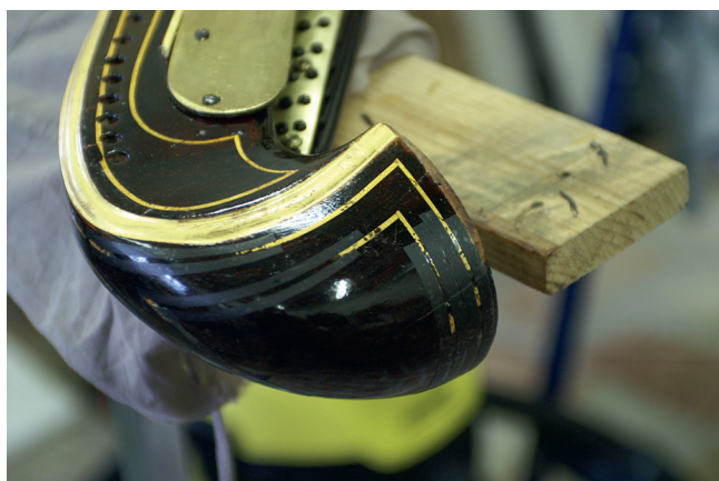
34. kép. A váll aranyfiléinek maszkolása a filék aranyozásához
