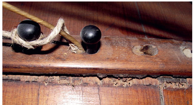
5. kép. A rezonátor keresztirányú törései a felső húrtartó mentén restaurálás előtt
