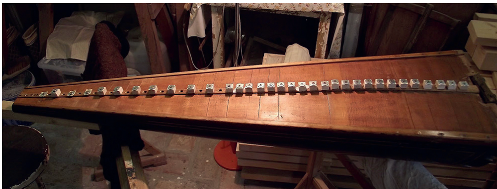
28. kép. A rezonátor visszahú- zása a húrok furatain kereszt- ülvezetett facsavarokkal tör- tént, melyeket a hangszekrény belsejébe helyezett stafnihoz csavaroztunk
