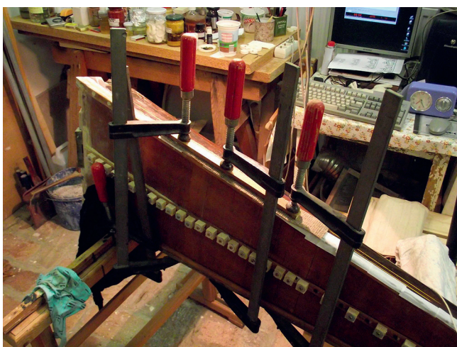
29. kép. Az oldalirányú terhelést pillanatszorítókkal egyenlítettük ki
