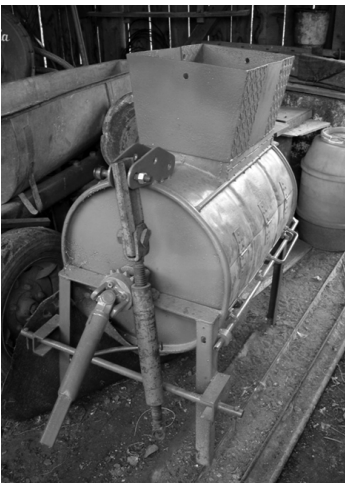
200 literes fémhordóból átalakított, traktorra szerelhető kukoricafejtő gép Fotó: Szabó Á. Töhötöm
