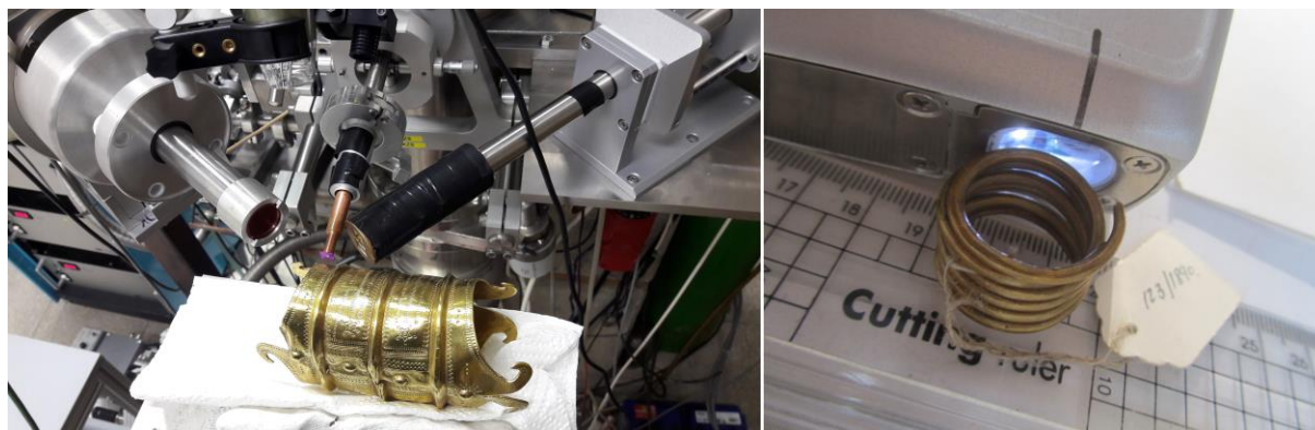
4. ábra: Bronzkori arany karpánt PIXE és hajkarika pXRF mérése (fotó: Kertész Zsófia, Maróti Boglárka).
