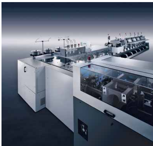
A Heidelberg Stitchmaster ST 450 irkafűző gépsor modulos meghajtórendszerrel van felszerelve, amely lehetővé teszi az egyes modulok egyedi kikapcsolását az energiamegtakarítás érdekében (Fotó: Heidelberger Druckmaschinen AG)
