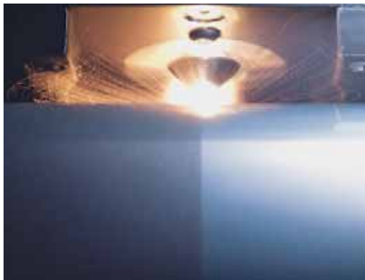
Anilox henger lézeres gravírozása
