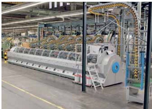
A Ferag svájci magazin- és napilap-specialistánál az automatikus beigazítási folyamatok UniDrum összehordó-fűző dobjaikon az alapfelszereltséghez tartoznak, a PreTronic előbeállító rendszernek köszönhetően (Fotó: Ferag AG)
