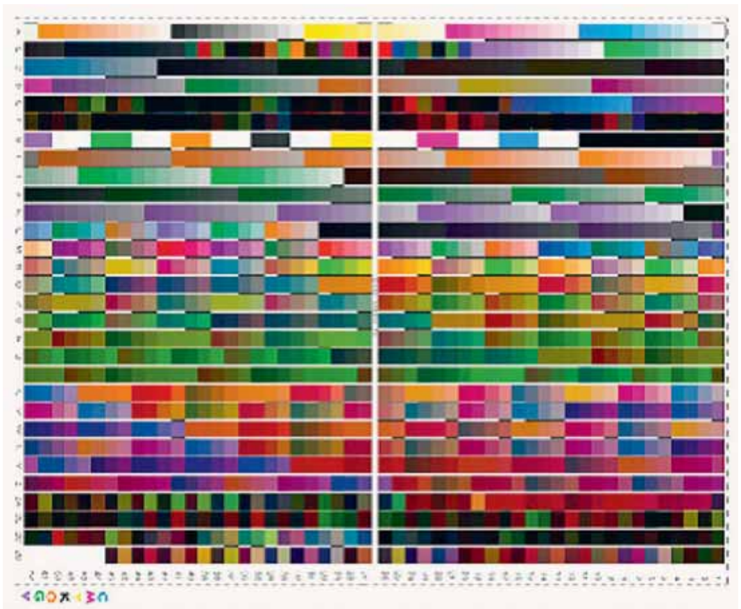
1. ábra. ECG tesztábra hét színcsatornával, CMYK+OVG
