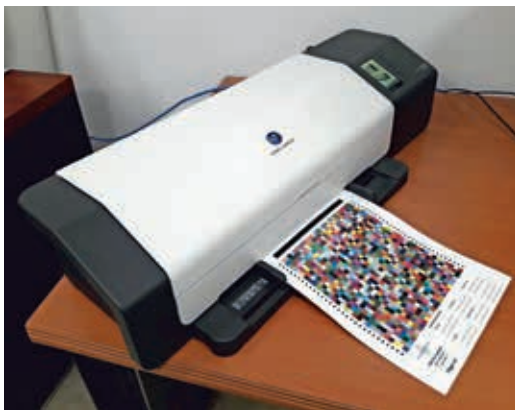
1. ábra. Konica Minolta FD-9 asztali spektrofotométer
