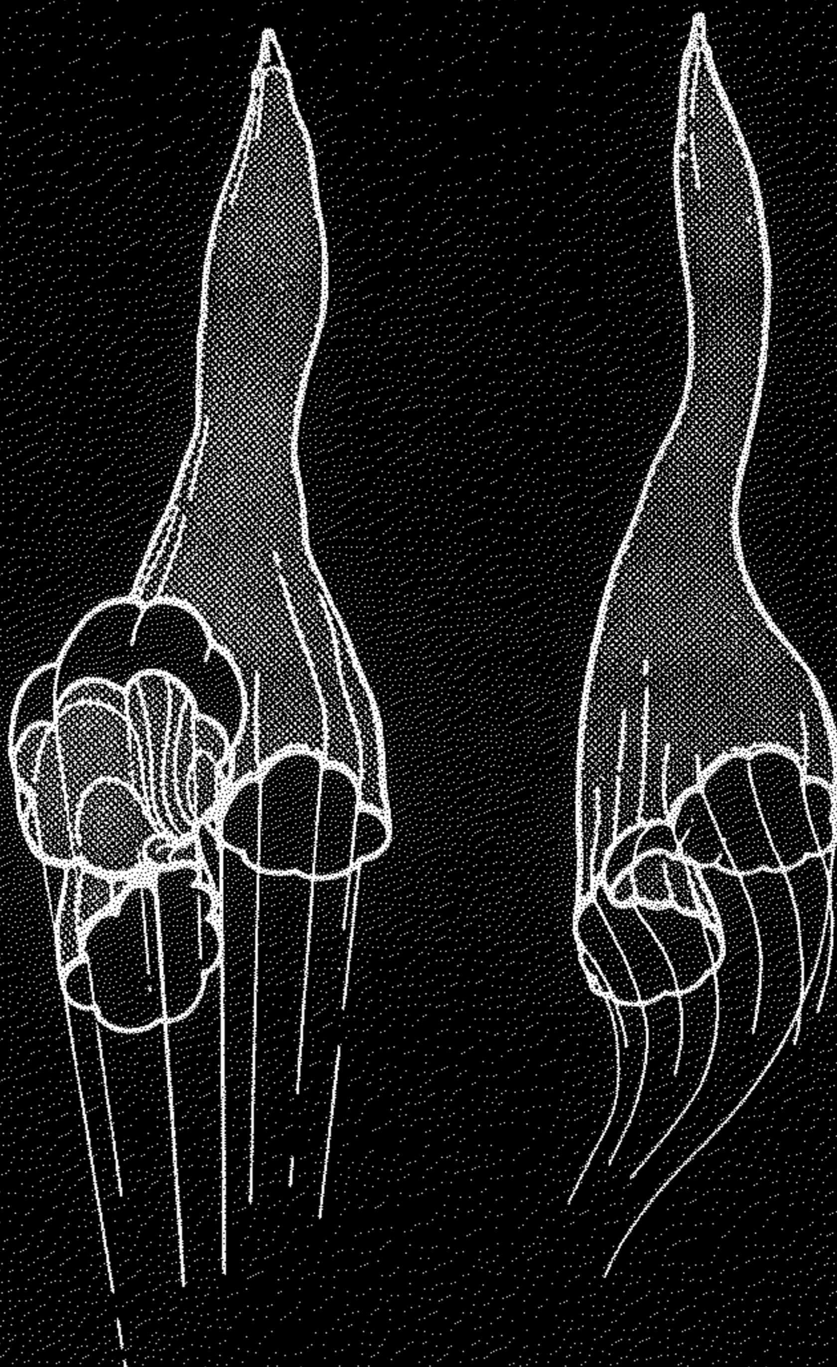
7. ábra Szálátsapódás kialakulásának kezdeti fázisa.
