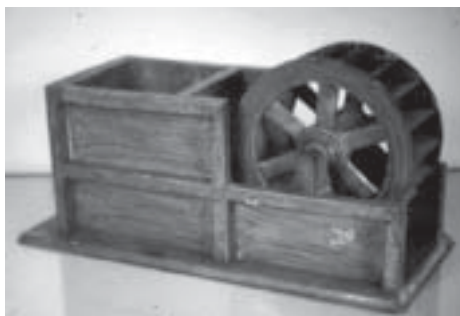
Alulcsapott vízkerék dinamikus modellje a budapesti Evangélikus Gimnázium szertárából
