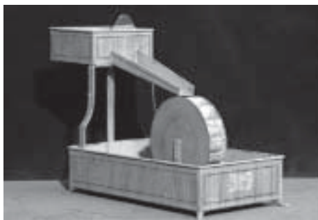
Felülcsapott vízkerék fémről készült, dinamikus modellje az OPKM gyűjteményéből
