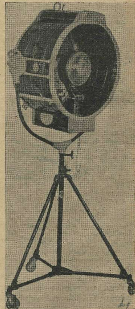
A Bardwell és McAlister „T5” jelzésű lámpája. Az izzószál előtt tisztán kivethető a kisátmérőjű körbordás lencse. Ez biztosítja a kivetített sugár mellékfénymentességét és az izzólámpafegyverzet árnyékának eltűnését.
