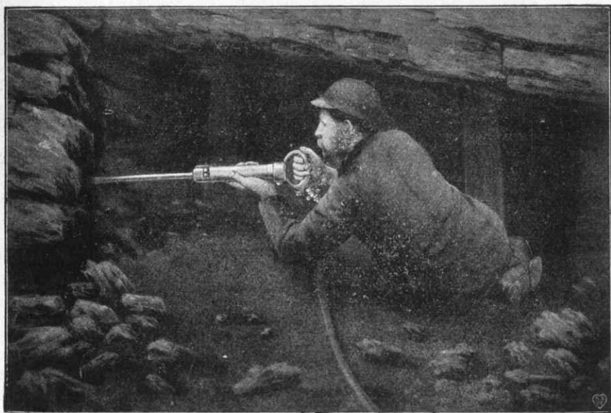
9. sz. rajz. „Westfália“ szén-fejtő fúró-pöröly, üzem közben.
